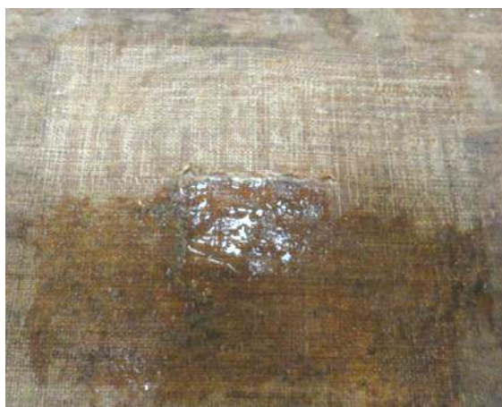
Un gel de carboxy méthyle cellulose permet de ramollir la colle qui est ensuite grattée (partie supérieure de la photo).
